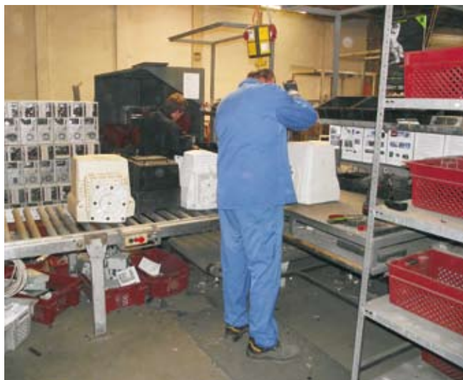
Die Mitarbeiter von Adamec prüfen, ob die einzelnen Gerätekomponenten wiederverwendbar sind oder nicht
