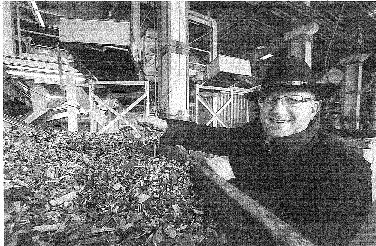
Der Unternehmer Thomas Adamec tüftelte 13 Jahre lang an der Anlage. Im Bild: Zerkleinerte Leiterplatten und Kabel — sie werden nach den verschiedenen Kunststoffen noch weiter getrennt. Foto: Eduard Weigert
